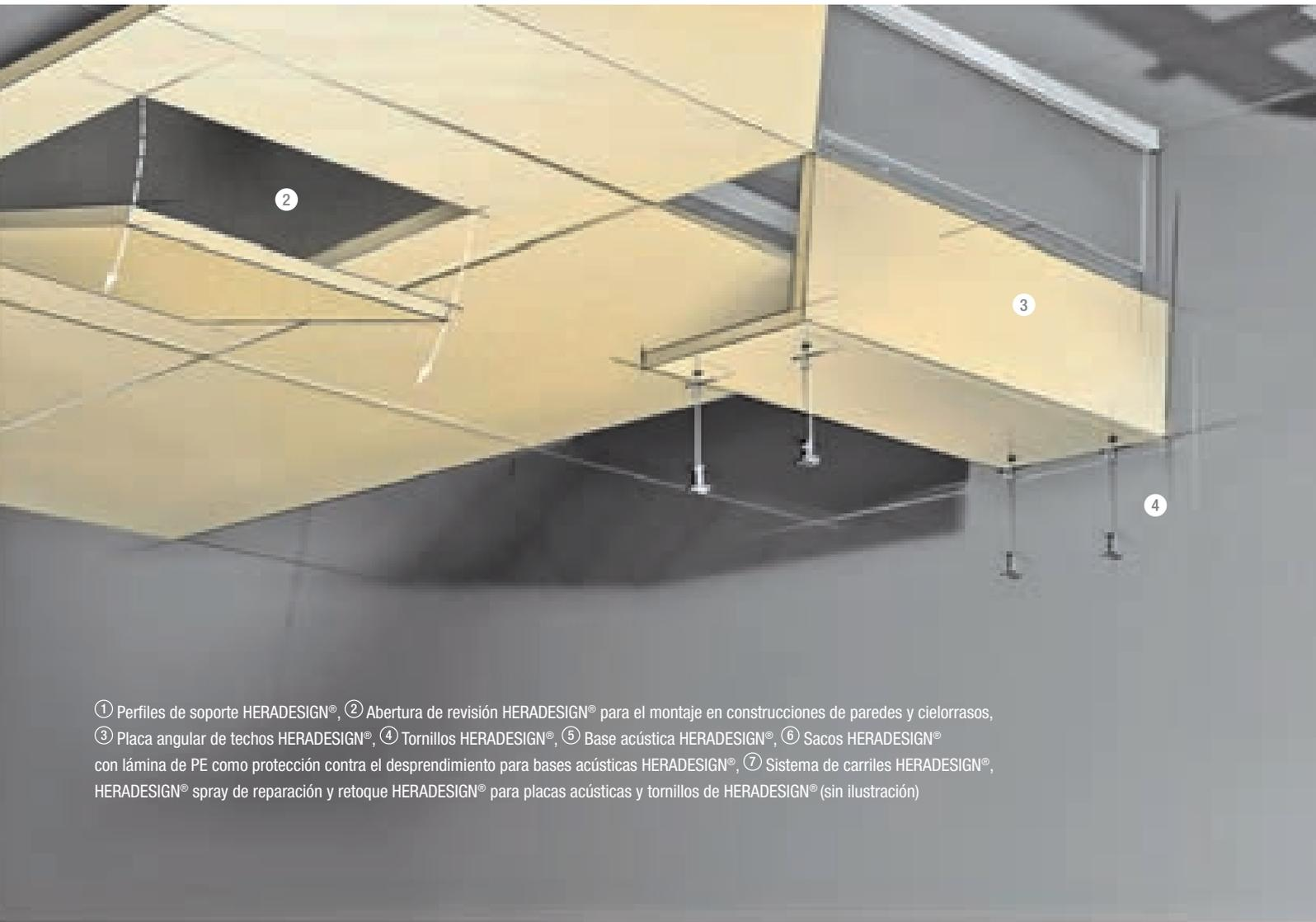
① Perfiles de soporte HERADESIGN®, ② Abertura de revisión HERADESIGN® para el montaje en construcciones de paredes y cielorrasos,
