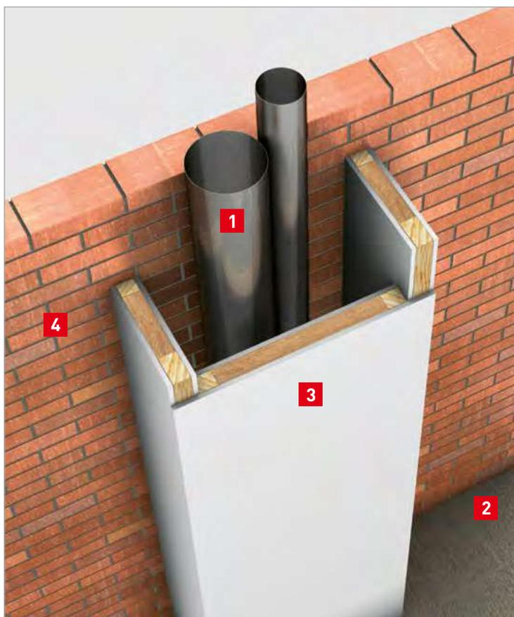
■ Aislamiento acústico de bajantes y tuberías
