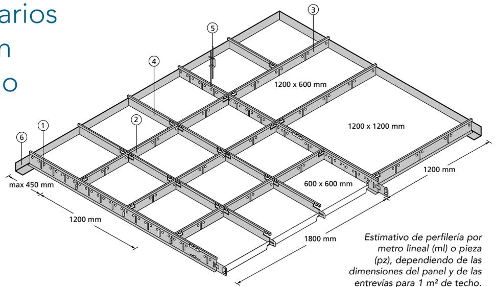
Estimativo de perfilera por metro lineal (ml) o pieza (pz), dependiendo de las dimensiones del panel y de las entrevías para 1 m<sup>2</sup> de techo.
