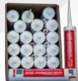
**MASILLA INTUMESCENTE Tecbor® USO EXTERIOR.** Sellador a base de caucho de silicona de reticulación neutra resistente al fuego. Sellador de un componente, de fácil aplicación, reticuable a temperatura ambiente, con resistencia a la llama. Aplicar con lana de roca como fondo de junta.
