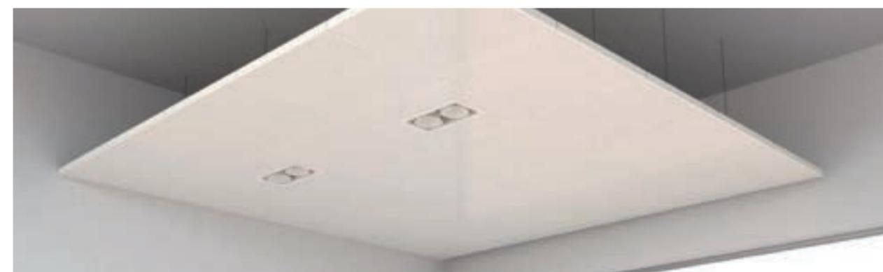
Bandejas conformadas por plegado, fabricadas con chapa de acero galvanizado prelacado de 0,50 mm de espesor (consultar otros espesores). Existe la opción de fabricar las bandejas en aluminio de 0,60 mm de espesor. Todas las bandejas son suministradas con film adhesivo de protección.
