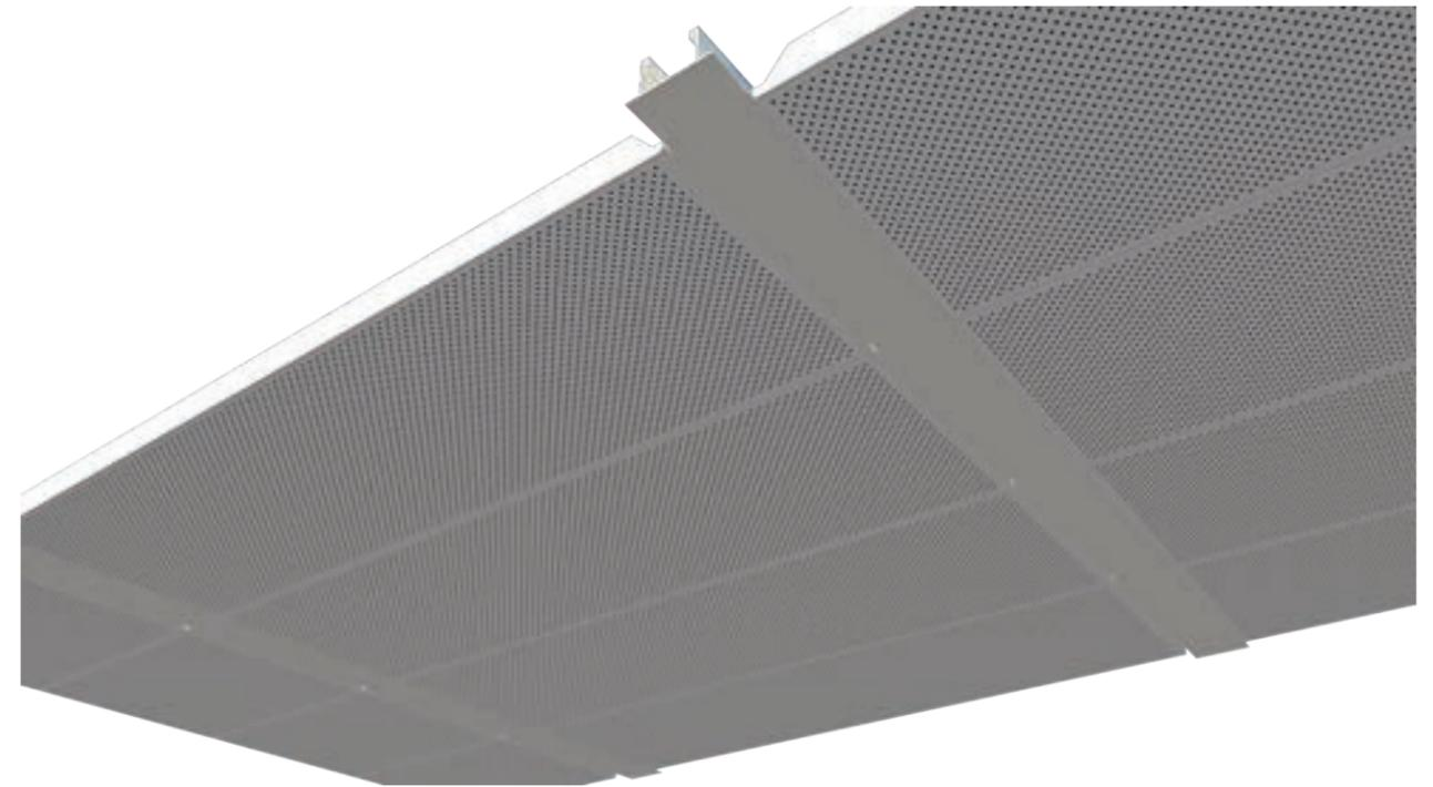
**Techo técnico de THU modelo SIENA** consiste en paneles especialmente fabricados para su instalación por apoyo a carriles desmontables como lo son perfiles T15, T24, T35 o perfiles DP en sus diversas medidas. Los paneles una vez instalados quedan atestados unos con otros en su lado más largo y descolgados 10mm respecto al perfil de apoyo en su lado corto.
