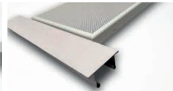
Bandejas prelacadas en Poliéster con un espesor de capa de mínimo 25 micras en color Blanco (RAL 9010) o Silver (RAL 9006). Este tipo de acabado se caracteriza por una alta resistencia a la corrosión y durabilidad (retención de brillo y color).
