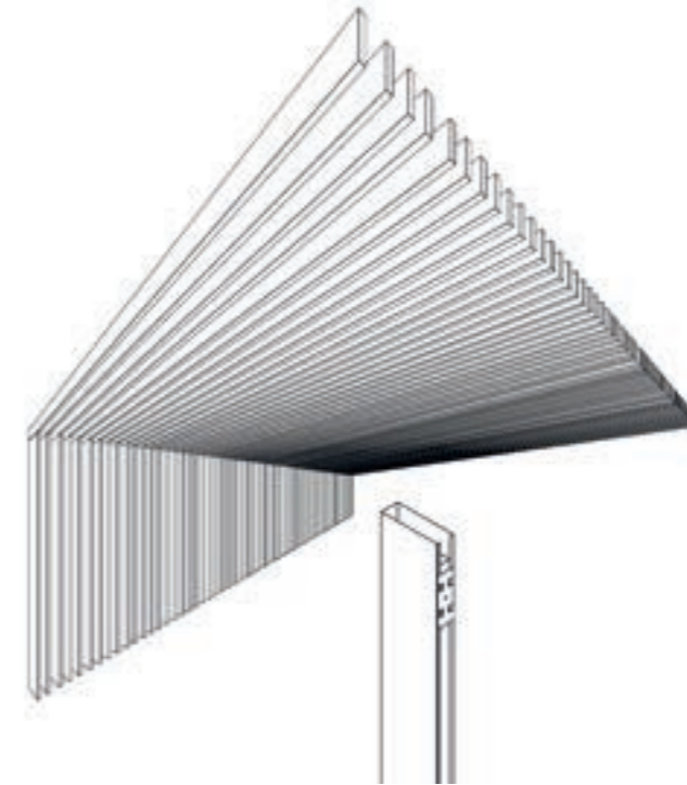
Pieza de cierre superior: Solución para instalación en vertical.
