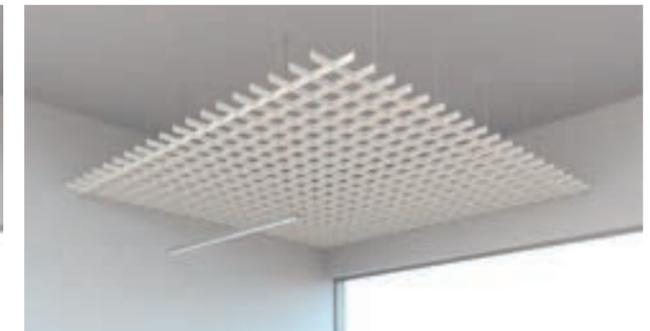
Rejillas fabricadas con aluminio prelacado de 0,40 mm de espesor más recubrimientos. Rejillas prelacadas en Poliéster con un espesor de capa de mínimo 20 micras en color Blanco y Silver THU 9006.
