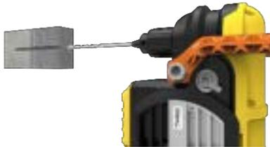
1. Realizar el taladro sin percutor con broca de diámetro 8 mm. La profundidad del taladro en el soporte debe estar entre 45 mm y 80 mm
