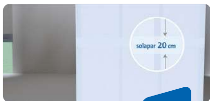
COLOCACIÓN LÁMINA IMPERMEABLE
