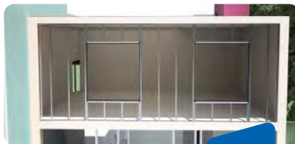
INSTALACIÓN ESTRUCTURA THM Y THR PARA HOJA EXTERIOR
