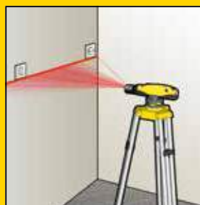
◀ Nivelación y alineación horizontal y vertical
